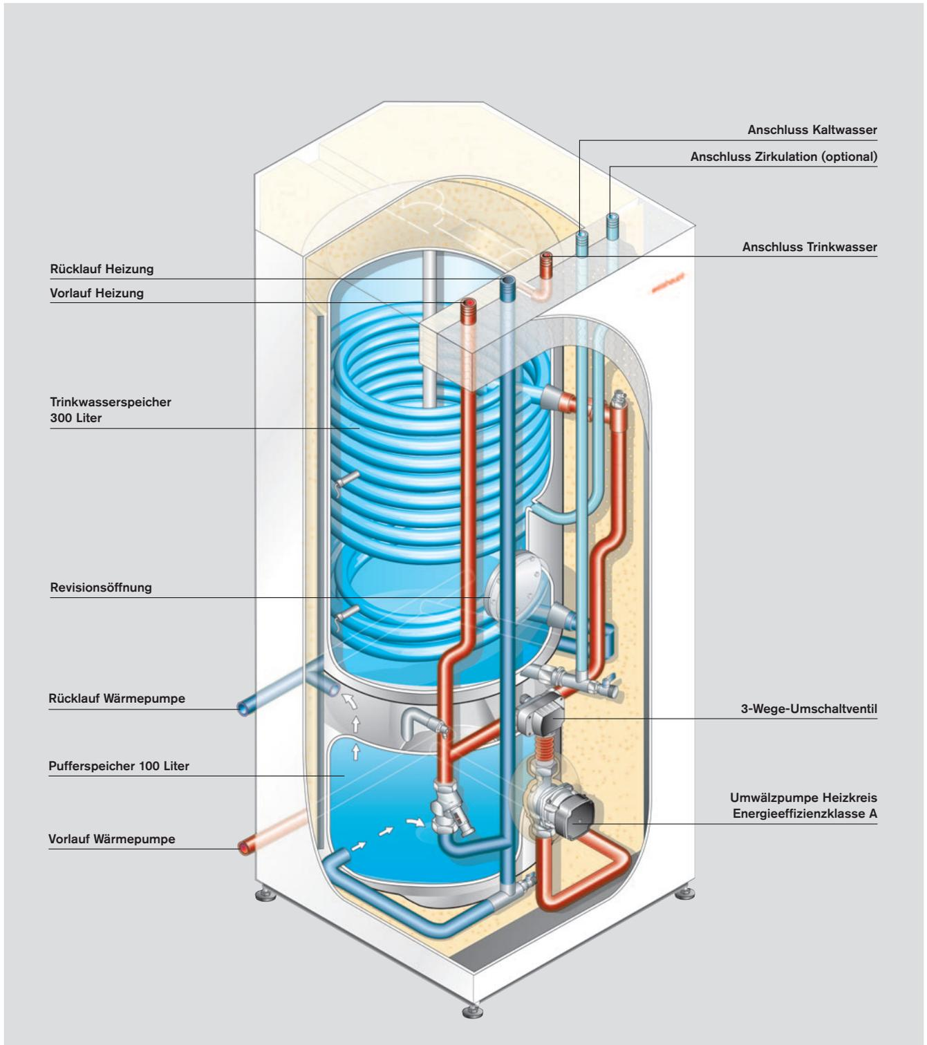
Weishaupt Kombispeicher WKS 300 / 100 LE / Unit-E / Bloc / C für Biblock-Wärmepumpen
