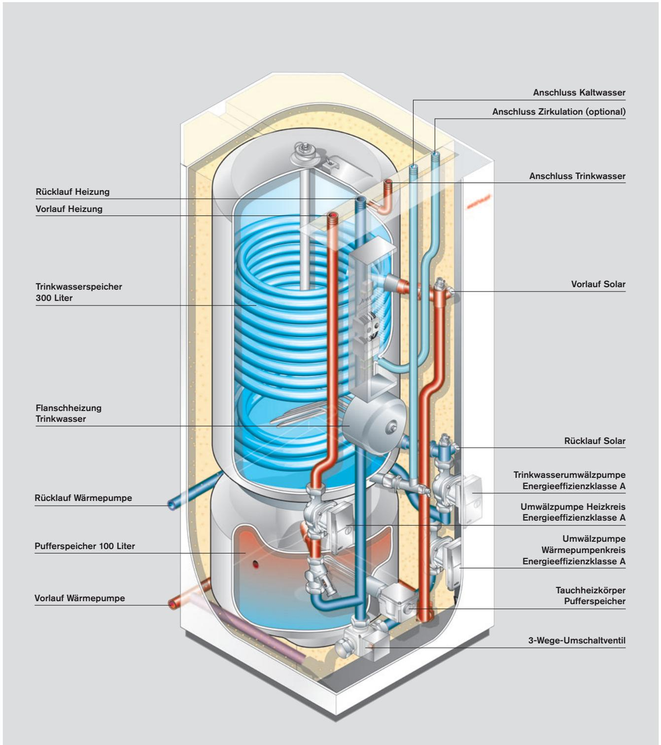
Weishaupt Kombispeicher WKS 300 / 100 LE / Unit-E / Bloc / B für Monoblock-Wärmepumpen
